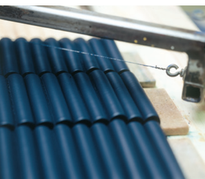
Pastelle werden mit einem drahtbespannten Rahmen zugeschnitten. Wire-strung frame for cutting the pastels.
